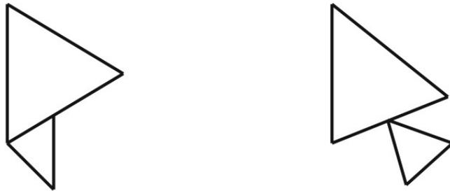
Figura 9.4: Configuraciones no admisibles en la triangulación.
